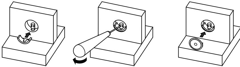
Порядок сборки сегментных стяжек: в отверстия царги вставить сегменты и с помощью шила завернуть винты до упора.
